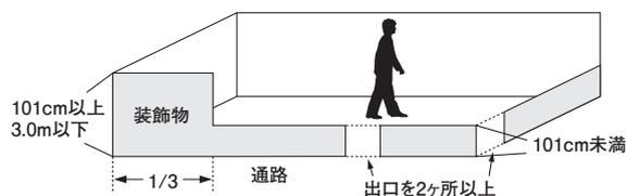
【平面図】 ※装飾物の高さが101cm以上3m以下の場合
